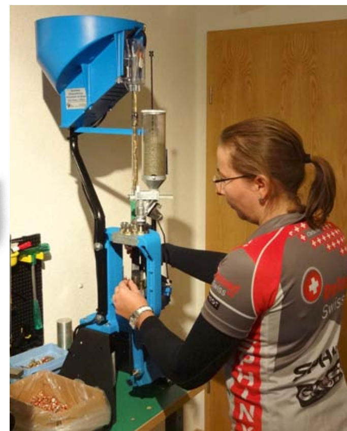
Die Wettkampfwaffe: Sphinx 3000 Production im Kaliber 9 mm Luger, Schlitten, Oberteil und Griffstück aus Stahl, Griffschalen Alu. Die Munition: 124-grs-Geschoss und Hülse von GECO, 4,8 grs RS20 von Reload Swiss®, Federal Small Pistol Primer, das Ganze auf 29,3 mm Patronenlänge auf der Dillon 650 zusammenlaboriert.
