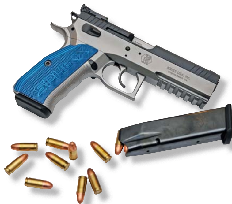
Die Wettkampfwaffe: Sphinx 3000 Production im Kaliber 9 mm Luger, Schlitten, Oberteil und Griffstück aus Stahl, Griffschalen Alu. Die Munition: 124-grs-Geschoss und Hülse von GECO, 4,8 grs RS20 von Reload Swiss®, Federal Small Pistol Primer, das Ganze auf 29,3 mm Patronenlänge auf der Dillon 650 zusammenlaboriert.
